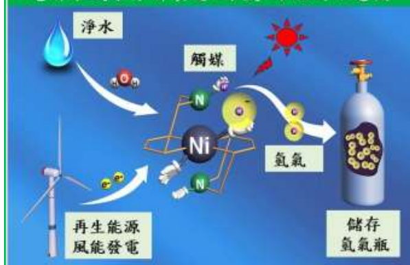
電解水或水分解製造<綠氫>方法的示意圖
